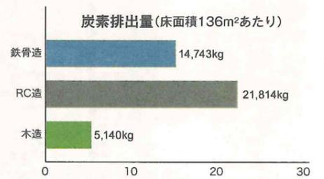
木造住宅でも、基礎には鉄筋コンクリートを使わないわけにはいきません。サッシもアルミニウムでできています。それでも、鉄骨造や鉄筋コンクリート造に比べると、半分から4分の1程度のCO<sub>2</sub>排出量で木造住宅はできあがっています。木造住宅は、やはり地球環境に貢献する家なのです。
