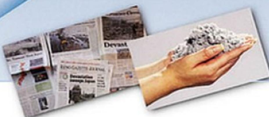
セルローズファイバーは、新聞紙をリサイクルして製造された天然木質性繊維の断熱材です。天然の木質繊維でできた新聞紙を、細かく碎いて、自然にできた空気胞を生かし、断熱性能があり、木から生まれた温もりがあります。断熱性能だけでなく多くの付加価値を持ち合わせており、安全性・環境面にも優れています。屋根・天井(勾配天井対応)・壁・床下に施工でき、「夏は涼しく」「冬は暖かく」快適な空間を創り出します。
